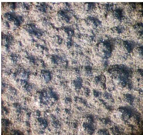
Фиг. 1. Вид под микроскопом покрытия из УВТК на подложке из УУКМ (образец № 2): (ширина поля – 3,5 мм)
