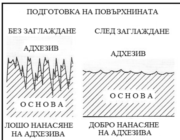
Фиг. 2. Нанасяне на адхезива в зависимост от предварителната подготовка на повърхнината
