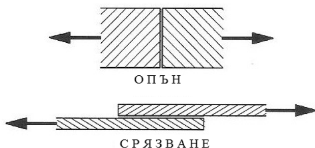
Фиг. 5. Залепено съединения, подложено на опън и на срязване
